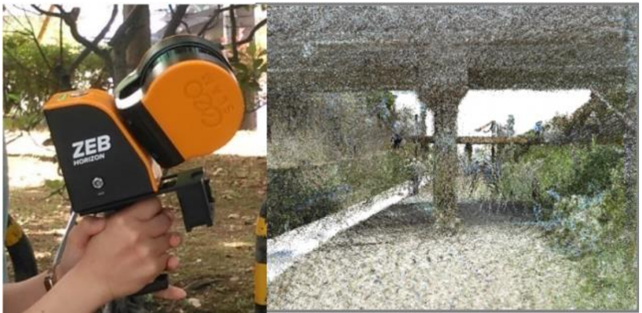
図 2 : 手持ちレーザスキャナによるレーザ点群計測
