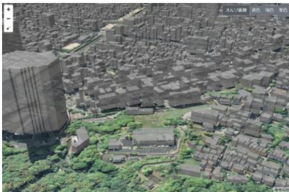
図 都市計画基礎調査データを活用して再現された3次元都市モデルの例
